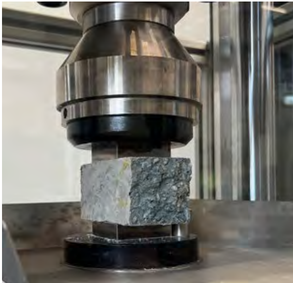
Versuchsaufbau zum Prüfen der Druckfestigkeit
