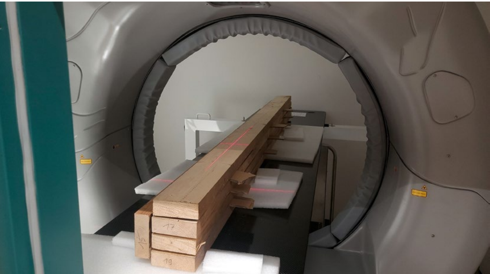
Computertomograph mit Holzbohlen aus Kiefer in Wiederverwendung als Komponenten für Brettschichtholz
